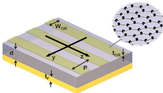
如上图所示，石墨烯条带放在金衬底上，中间用一个厚度为  $d$  的电介质层隔开。图中  $W_{GR} = 1 \mu\text{m}$ 、 $P = 2 \mu\text{m}$ 、 $t_{GR} = 1 \text{nm}$ 、 $t_F = 1 \mu\text{m}$ ， $d$  在  $1 \sim 100 \mu\text{m}$  间变化。金的电导率为  $4 \times 10^7 \text{ S/m}$ 、电介质的折射率为 2.1、石墨烯的电导率由 Kubo 公式的近似公式来定义：
