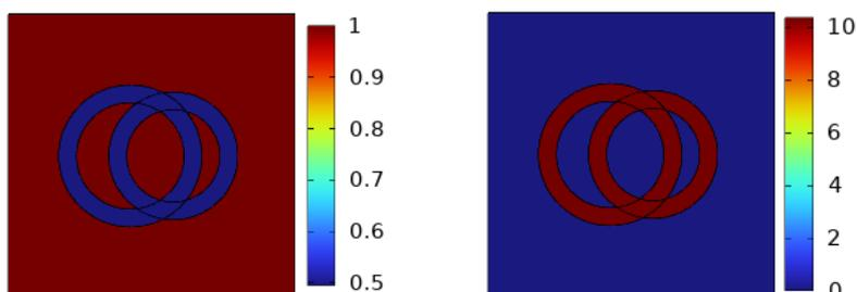
6、波长 1500 nm 处的介电常数实部、虚部分布（这张图论文中没有给出）：
