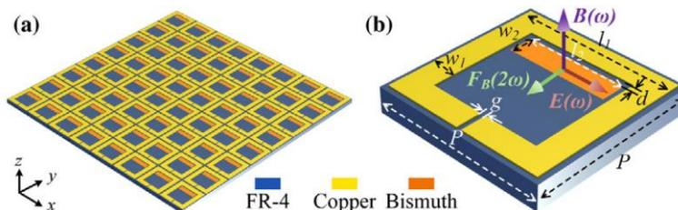
如上图所示，该超表面的基本单元是 FR-4 基板上的 Cu 开口环，环内镀有一层长方形的 Bi 金属薄层。一束频率为 10 GHz、沿  $x$  方向偏振的平面光从上往下入射，在 Bi 上会辐射出频率为 20 GHz 的二次谐波。图中  $l_1 = 3.4 \text{ mm}$ ,  $w_1 = 0.45 \text{ mm}$ ,  $g = 0.1 \text{ mm}$ ,  $l_2 = 2.3 \text{ mm}$ ,  $w_2 = 0.5 \text{ mm}$ ,  $d = 0.1 \text{ mm}$ ,  $P = 3.6 \text{ mm}$ , Cu 的厚度为  $30 \mu\text{m}$ , Bi 的厚度为  $100 \text{ nm}$ 。
