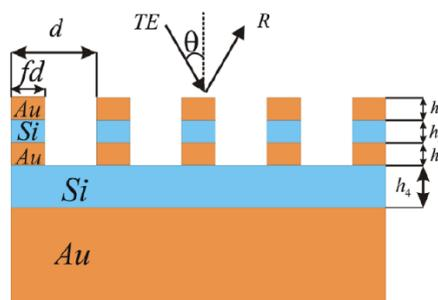
如上图所示，所计算的结构是放置在 Si/Au 衬底上的夹层光栅，光栅由 Au/Si/Au 夹层构成。图中  $h_1 = 18 \text{ nm}$ 、 $h_2 = 230 \text{ nm}$ 、 $h_3 = 18 \text{ nm}$ 、 $h_4 = 140 \text{ nm}$ 、 $d = 360 \text{ nm}$ 、 $f = 0.5$ 。Au 材料由 Drude 模型来描述：
