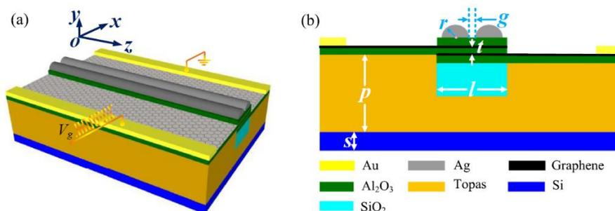
如上图所示, 调制器主体结构由两个半圆形的 Ag 纳米条带、Al<sub>2</sub>O<sub>3</sub> 绝缘体、石墨烯电容器组成, 该石墨烯电容器置于 Si 衬底、Topas (一种环烯烃类树脂材料) 和 SiO<sub>2</sub> 波导之上。图中  $s = 100 \text{ nm}$ ,  $p = 800 \text{ nm}$ ,  $l = 600 \text{ nm}$ ,  $t = 5 \text{ nm}$ ,  $r = 100 \text{ nm}$ ,  $g = 10 \text{ nm}$ 。
