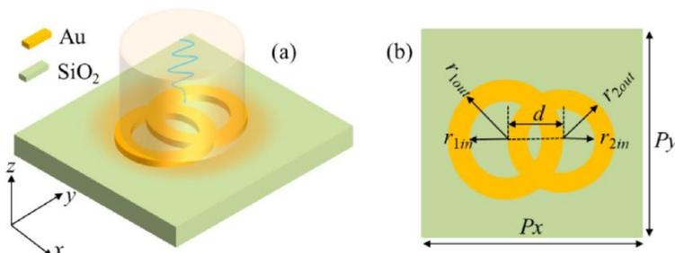
如上图所示，基本单元由两个交叉的金环构成，两个金环的大小不同，衬底是 SiO<sub>2</sub>。图中  $P_x = P_y = 400 \text{ nm}$ 、 $r_{1in} = 75 \text{ nm}$ 、 $r_{1out} = 100 \text{ nm}$ 、 $r_{2in} = 65 \text{ nm}$ 、 $r_{2out} = 90 \text{ nm}$ 、 $d = 60 \text{ nm}$ ，金环的厚度为  $50 \text{ nm}$ 。SiO<sub>2</sub> 的折射率取 1.45，Au 的折射率用 COMSOL 材料库中内置的 Au 材料。
