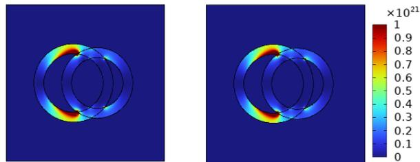
8、波长 1190 nm 处的电流密度分布矢量场图，左图是软件内置的结果，软件内置的结果没法单独画感应电流，它把空气中的位移电流也画出来了，右图是我自己写公式计算的结果（这张图论文中没有给出）：
