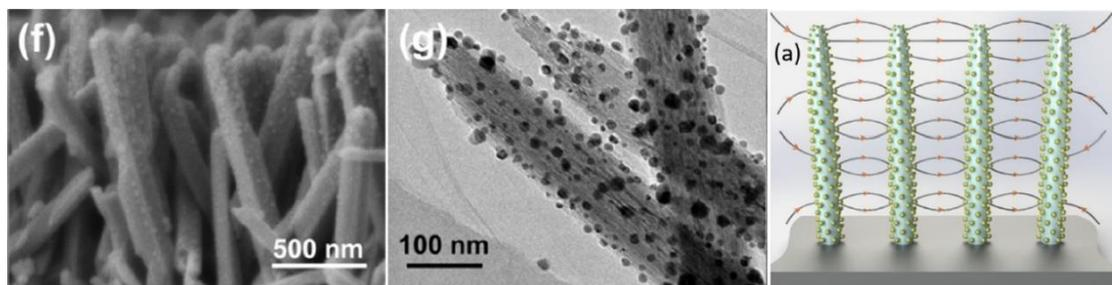
如上图所示, SERS 基底结构是由 Ag 纳米颗粒修饰的 TiO<sub>2</sub> 纳米线, TiO<sub>2</sub> 的直径为 100 nm, Ag 颗粒的直径为 9 nm。Ag 和 TiO<sub>2</sub> 的介电常数数据采用 Johnson & Christy 和 Tompkins 实验测量的数据。波长为 514 nm 的光从上往下正入射, 用 FDTD 仿真纳米线周围的电场增强。
