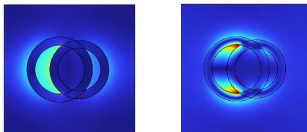
5、波长 1500 nm 处的折射率实部、虚部分布 (这张图论文中没有给出):
