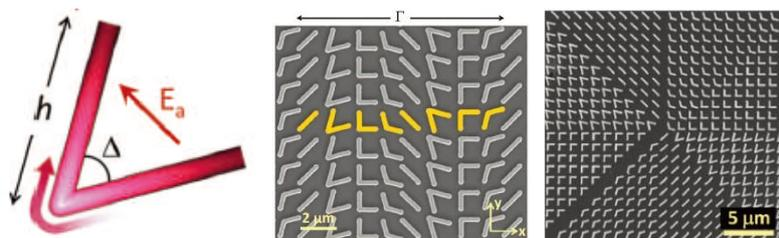
如上图所示，由不同夹角  $\Delta$  和臂长  $h$  的 V 字形金纳米天线放置在 Si 衬底上组成超表面。每个金纳米天线的臂宽和厚度分别为 220 nm 和 50 nm，排列周期是 1.5  $\mu\text{m}$ ，上面中间那张图的 8 个典型结构对应的尺寸分别为：
