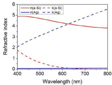
如上左图所示, 结构是镀在玻璃衬底上的四层纳米级薄膜。波长为 400~800 nm 的可见光从上往下入射, 计算其吸收率。a-Si 和 Ag 的复折射率由实验测得, 都是关于波长的函数, 如上右图所示。
