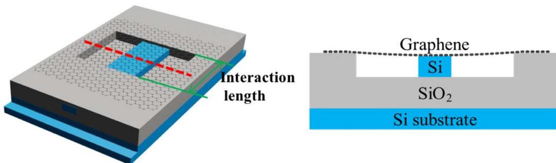
如上图所示，在 Si 波导上铺一层单层石墨烯。波长为 1550 nm 的泵浦光和 1549.5 nm 的信号光从波导中输入，实现四波混频。
